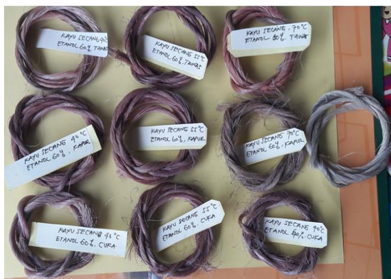
Gambar 7. Serat kenaf yang direndam filtrat kayu secang dengan pelarut etanol 60% pada temperatur 40°C, 55°C, dan dan 70°C dengan mordan tawas, kapur, dan cuka.
