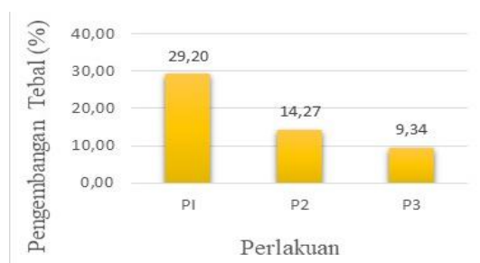
Gambar 4. Nilai Rataan Pengembangan Tebal Papan Komposit Plastik Berdasarkan Rasio Plastik Polipropilena (PP) dengan Campuran Serbuk Kayu Sengon dan Sekam Padi.
