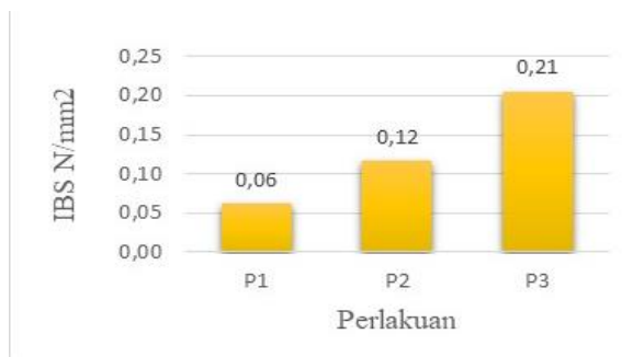
Gambar 7. Nilai Rataan Tarik Tegak Lurus Permukaan Papan Komposit Plastik Berdasarkan Rasio Plastik Polipropilena (PP) dengan Campuran Serbuk Kayu Sengon dan Sekam Padi.
