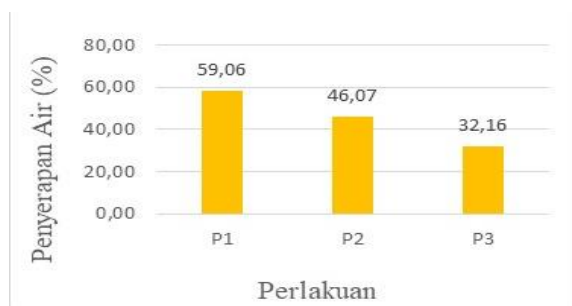
Gambar 3. Nilai Rataan Penyerapan Air Papan Komposit Plastik Berdasarkan Rasio Plastik Polipropilena (PP) dengan Campuran Serbuk Kayu Sengon dan Sekam Padi.
