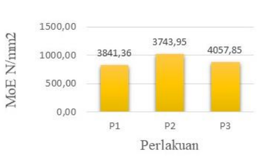
Gambar 5. Nilai Rataan Keteguhan Lengkung Statis (MoE) Papan Komposit Plastik Berdasarkan Rasio Plastik Polipropilena (PP) dengan Campuran Serbuk Kayu Sengon dan Sekam Padi.
